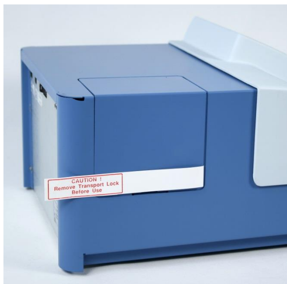
图 3. 运输锁（仪器内）和运输锁标签
