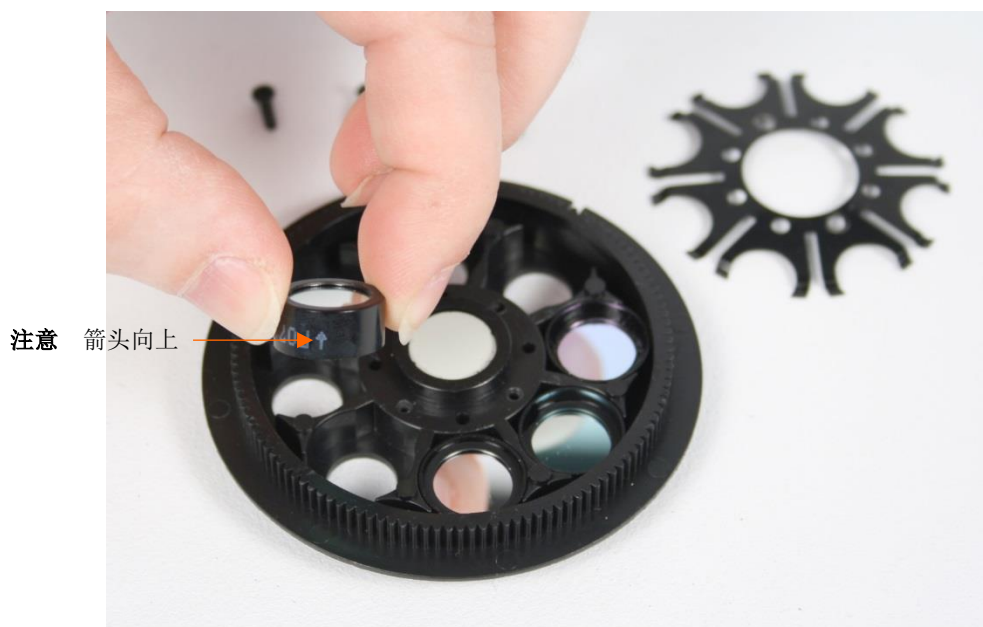
图 23. 将滤镜插入滤镜轮中下一个空闲位。
