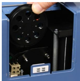
图 8. 将 Multiskan FC 滤镜轮放入滤镜槽中
