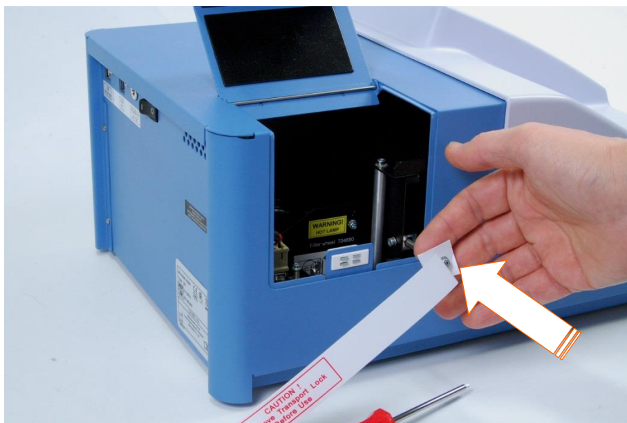
图 27. 将运输锁栓重装到测量头
