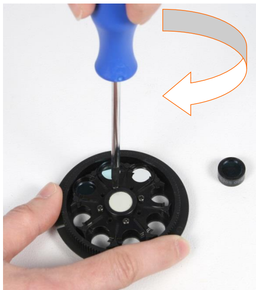
图 20. 取下弹簧锁紧螺丝
